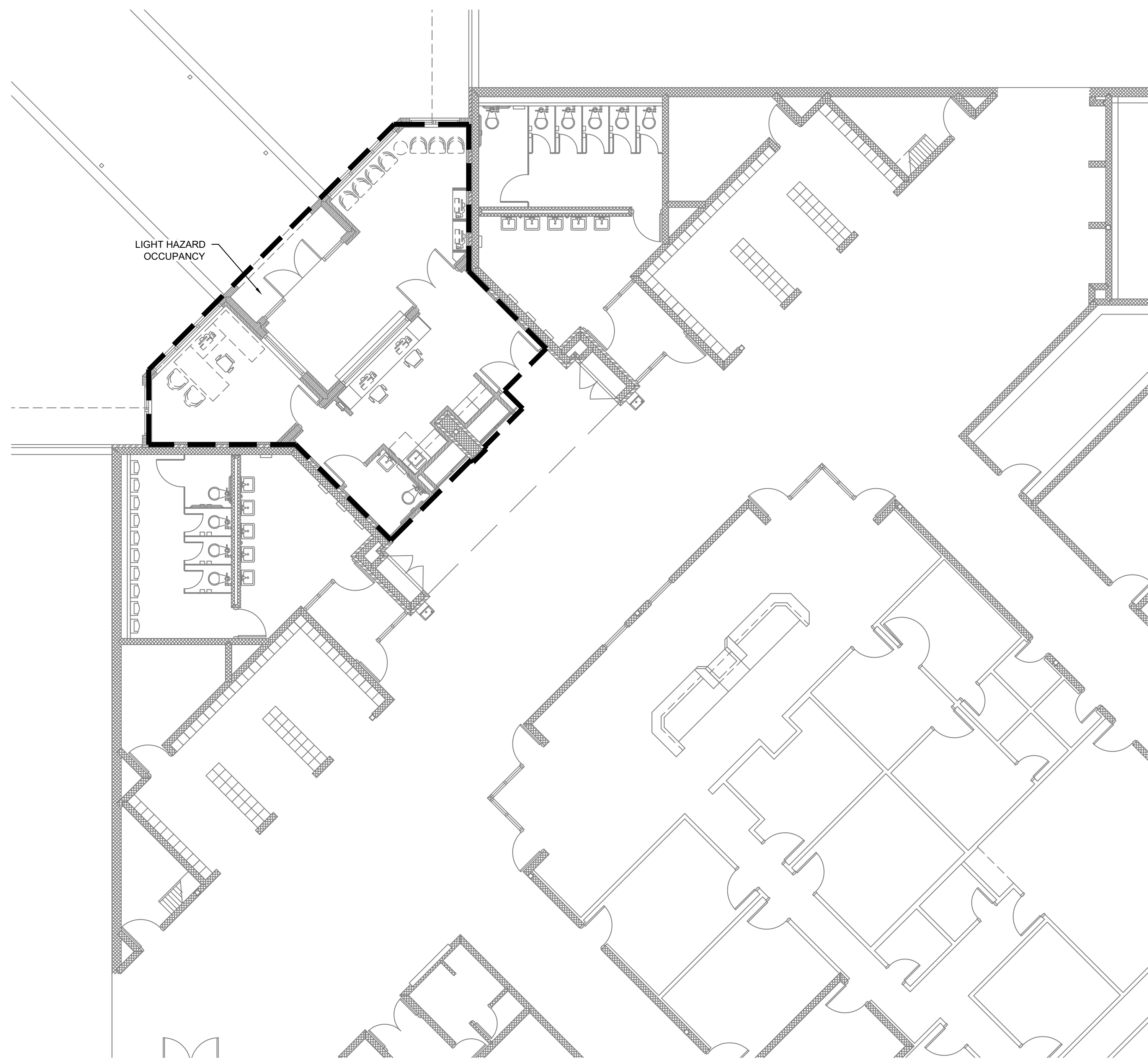
1 FIRE PROTECTION OCCUPANCY HAZARD ZONE MAP SCALE: 1/8" = 1'-0"
